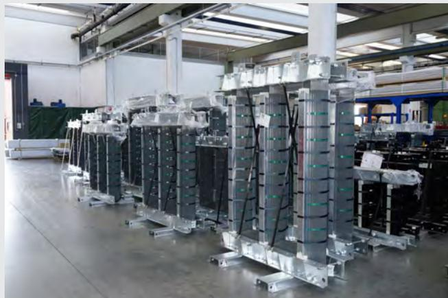
**МАГНИТОПРОВОД** - часть конструкции трансформатора, предназначенная для прохождения магнитного потока, возбуждаемого протекающим в первичной обмотке электрическим током. Материал магнитопровода - кремнистая электротехническая сталь. Стержни и ярма магнитопроводов в трансформаторах ASG соединены между собой по методу «Step-Lap», что улучшает прохождение магнитного потока, снижает ток холостого хода и шум. Данный метод обеспечивает повышенную механическую прочность магнитной системы.
